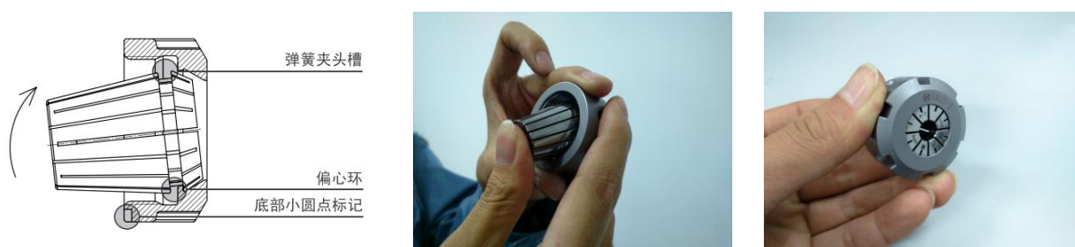
图 2-5 安装弹簧夹头
