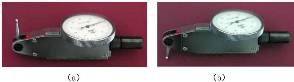
图 3-5 杠杆千分表的测杆可以按需转动 180^\circ
