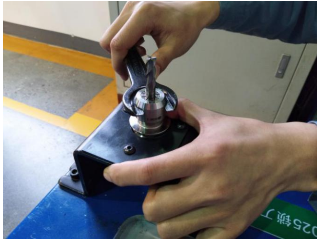
图 2-15 拆卸弹簧夹头、螺帽、刀具
