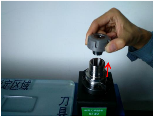
图 2-12 取下螺帽弹簧夹头
