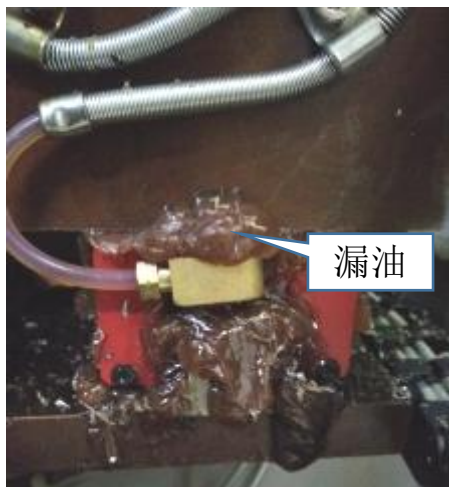
油管连接处漏油
