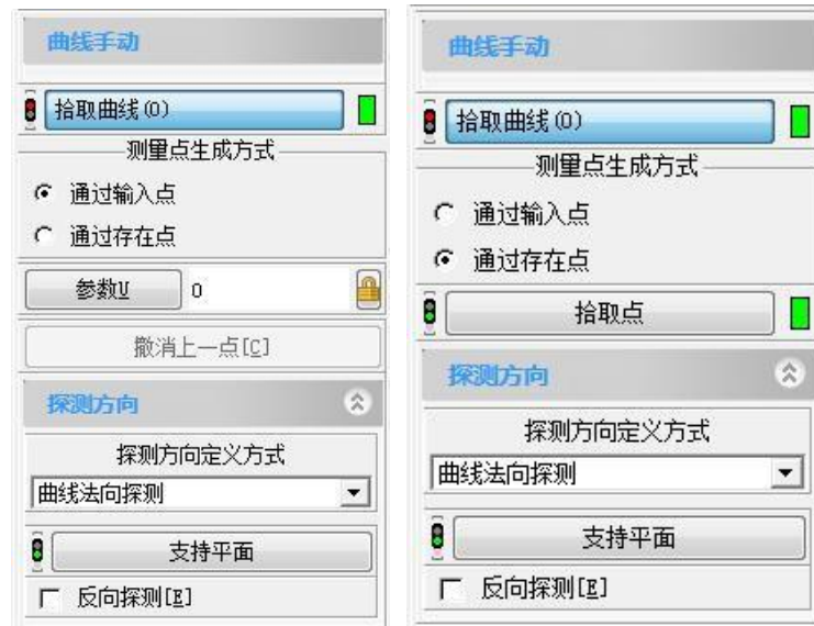
图 3 曲面手动：通过输入点（左）和通过存在点（右）
