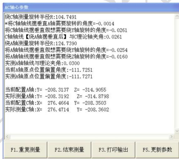
图 17 AC 轴测量结果
