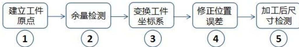
图 2-1 压铸件在机测量流程
