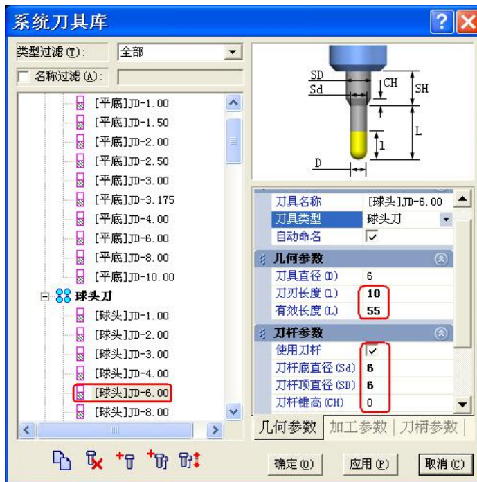
图 7-14 添加刀具并设置刀具参数
