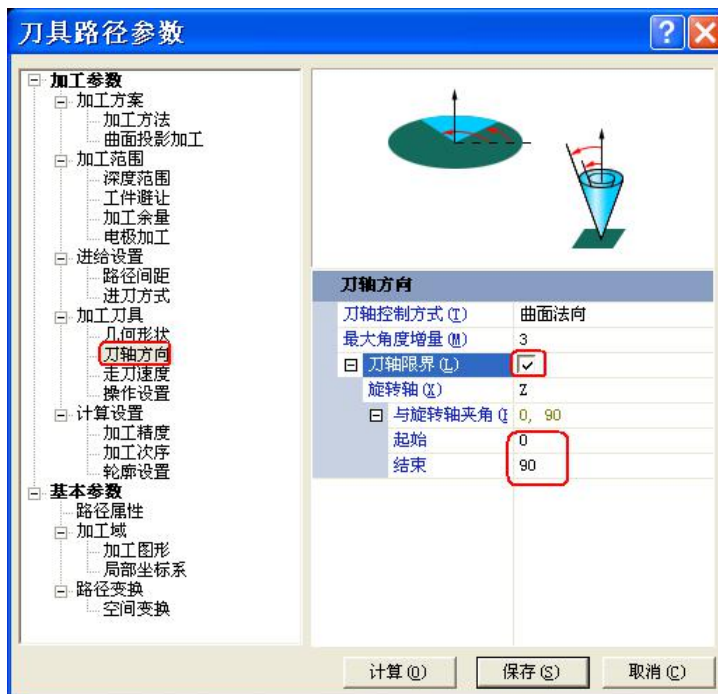
图 7-45 刀轴方向设置
