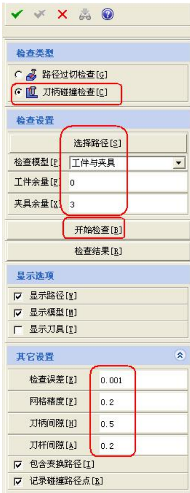
图 7-51 碰撞检查参数设置
