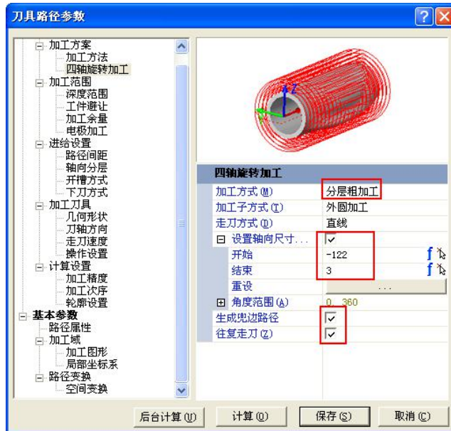
图 7-30 四轴旋转分层粗加工参数设置
