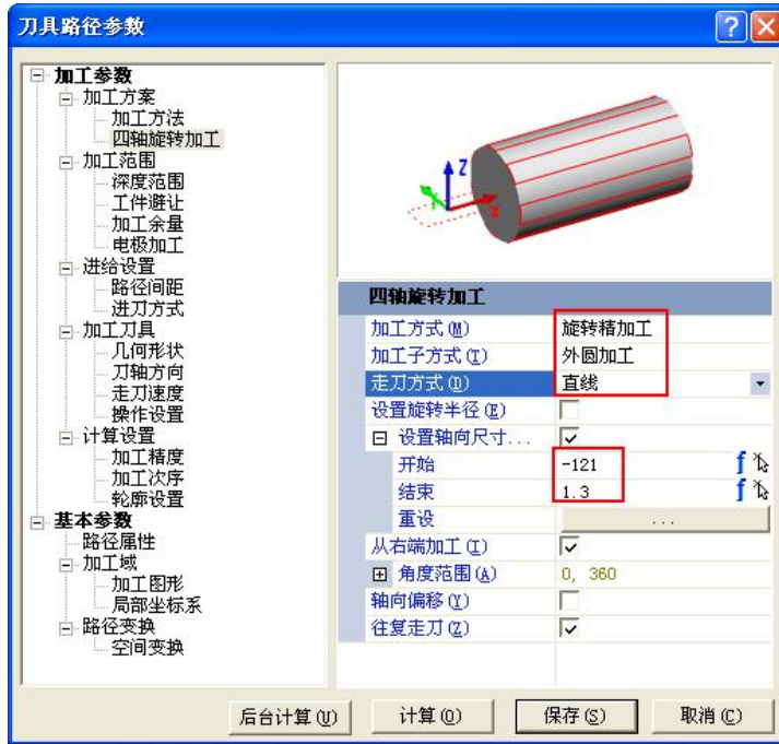
图 7-38 四轴旋转精加工
