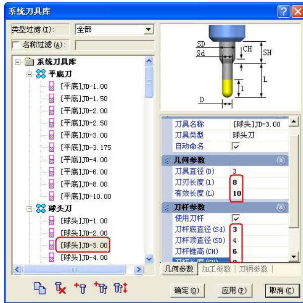
图 7-15 添加刀具并设置刀具参数
