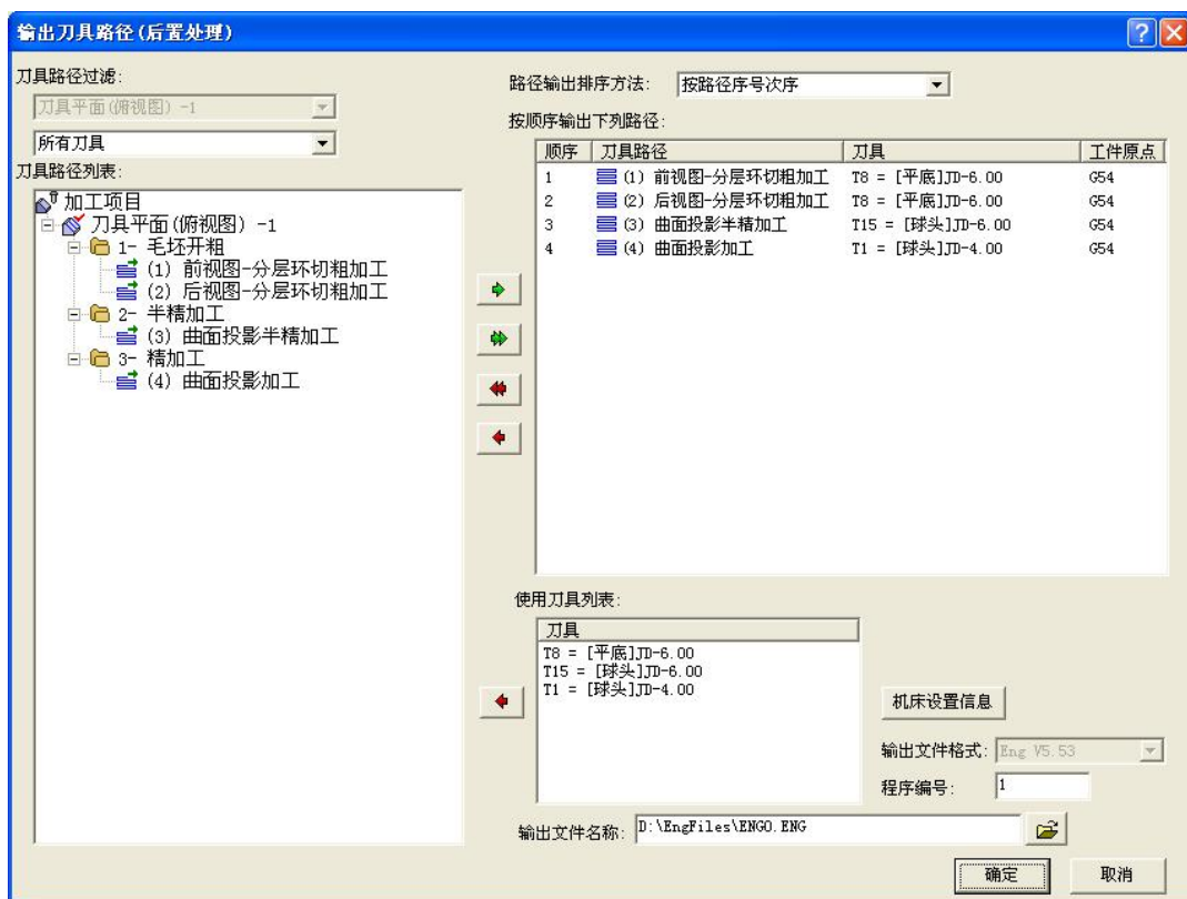
图 6-49 输出刀具路径 (后置处理)
