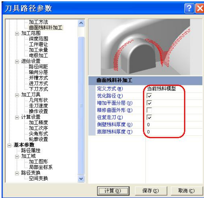
图 4-30 曲面残料补加工参数设置
