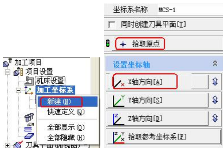
图 7-11 坐标系建立参数设置
