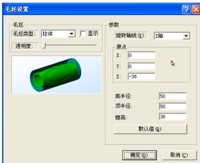
图 5-12 设置生成毛坯参数
