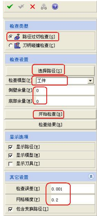
图 7-49 过切检查参数设置
