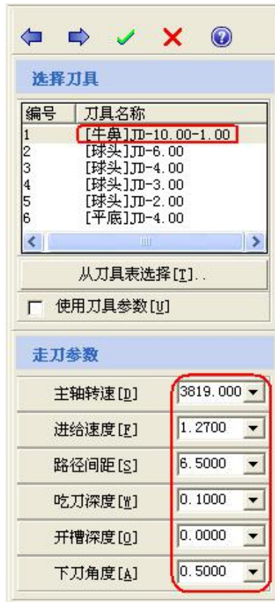
图 4-17 选择刀具及设置走刀参数
