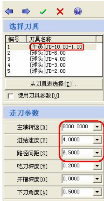
图 4-22 设置走刀参数及走刀参数
